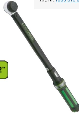
Achtung: Entlasten Sie nach jeder Anwendung durch Zurückdrehen des Schlüssels auf 0-Stellung den Drehmomentmechanismus.
